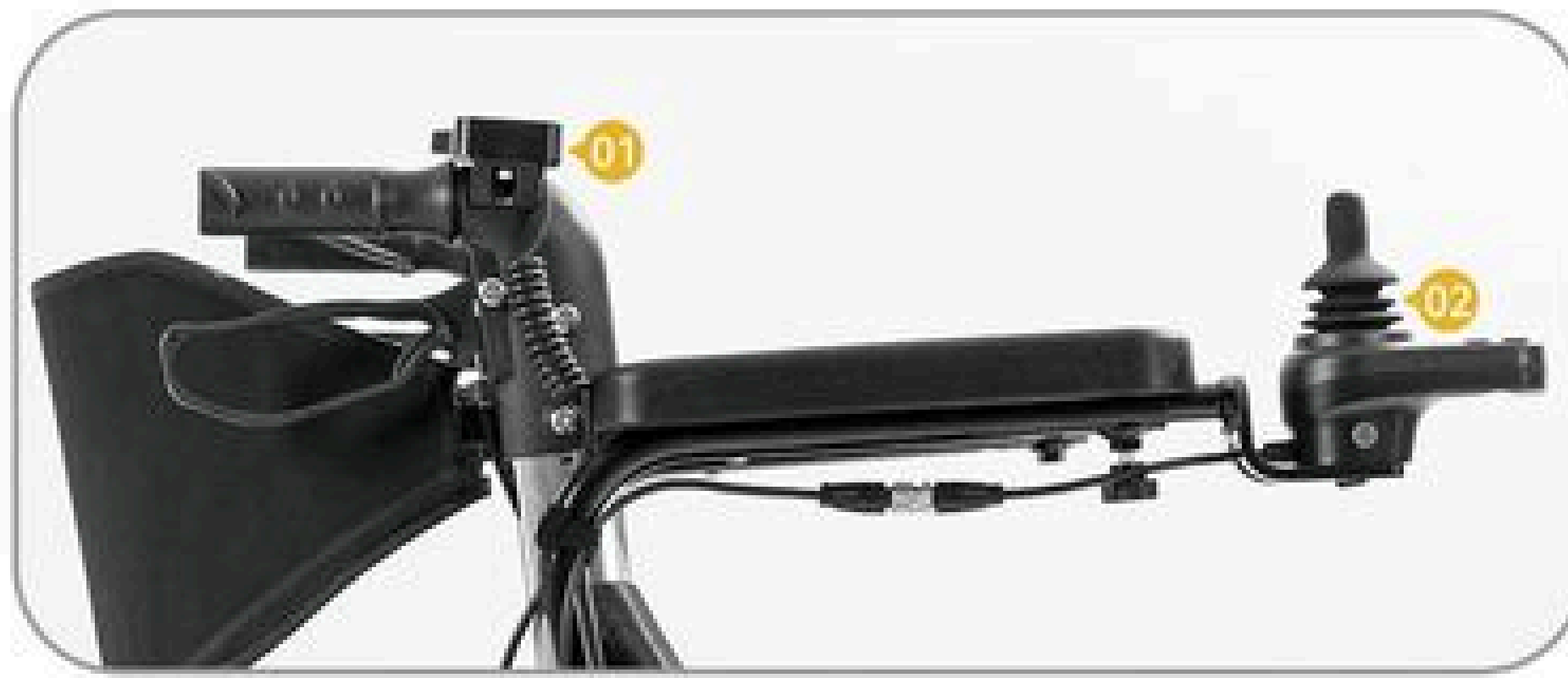
双控制器系统 Dual controller system
